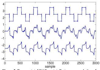
Figure 5. Top :  $v_{Lp}(n)$ , Middle : y(n), Bottom : convolution of  $a_{exc}(L_{exc}-n)$  and  $v_{Lp}(n)$
