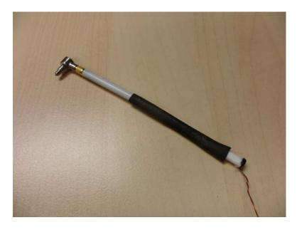
Fig. 3.9 Impact Hammer Model 086E80
